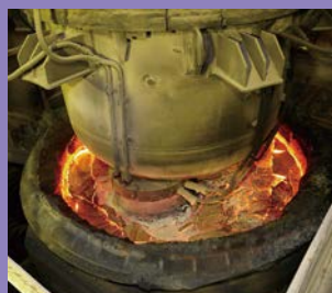
RH真空脱ガス設備 RH vacuum degasser
