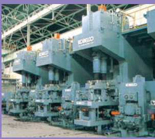
精密圧延機 Precision rolling mill
