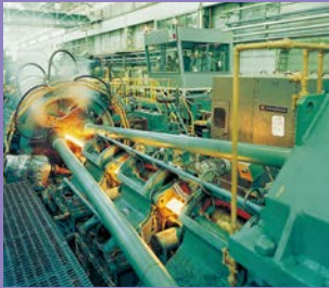
アッセルミル Assel tube rolling mill
