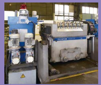
棒鋼用フェイズドアレイ超音波探傷機 Phased-array ultrasonic inspection machine for steel bars
