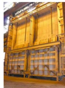
自由鍛造用加熱炉
