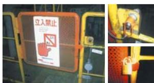
設備稼働区域では、作業者が誤って機械を止めずに侵入するのを防ぐため、安全柵、安全プラグスイッチ（扉を開けると自動的に設備が停止）の設置、扉の施錠を行い、ヒューマンエラーによる災害を防止しています。
