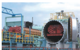
加圧式蒸気エージング設備
