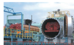
加圧式蒸気エージング設備
