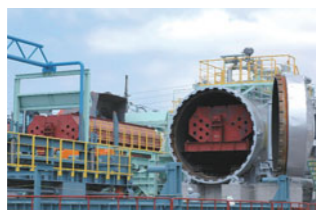
加圧式蒸気エージング設備
