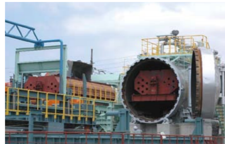
加圧式蒸気エージング設備
