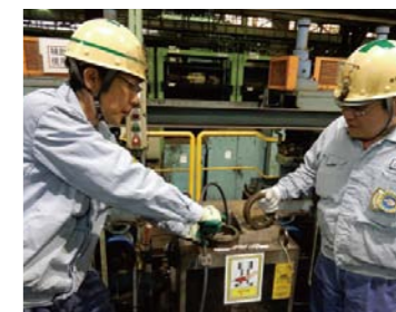
技能伝承の様子(渦流探傷機セット替え作業)
