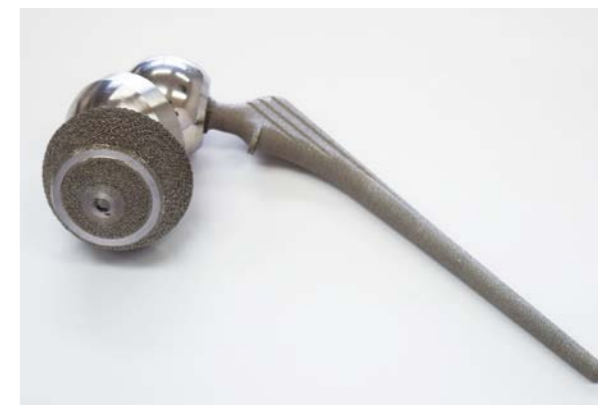
3Dプリンターを使用した造形例（人工関節） 東北大学金属材料研究所 千葉 晶彦 教授 提供
