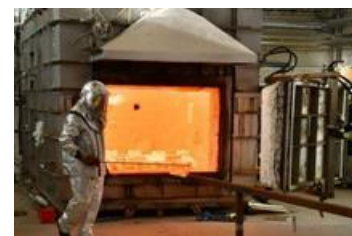
【ピット炉での鋼片加熱の様子】
