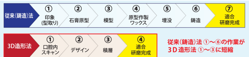
■ 従来の鋳造法と3D造形法との工程の違い
