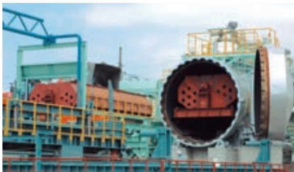
加圧式蒸気エージング設備
