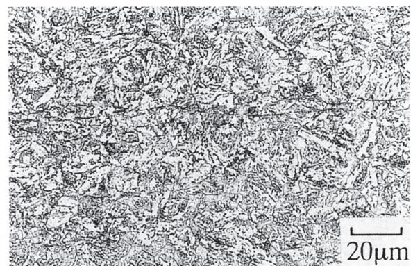
図1 TMAX2の断面硬さ分布およびミクロ組織 (φ30)
