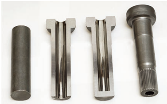
図23 張力付加押し出しで作成した製品 27)
