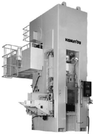
図14 630トン冷間鍛造用サーボプレス 18)
