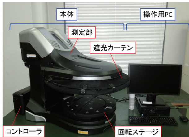
図2 3Dスキャナ型三次元測定機の外観
